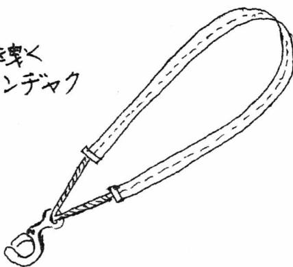
ある。カジ棒は特別な装置ではなく、積載した木材の中から一本を選び（櫛を引く人の胸の高さの木材）、引き手の届く位置まで引き出しておく。カジとなる木材の先端には握りやすいように大型のカスガイを打ち込んでおく。
